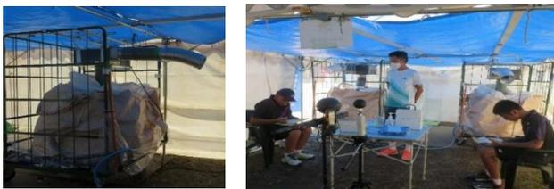
雪を利用した空調装置を4台設置し、テント内を冷却した。空調装置1台あたり、500kgの雪を1つのフレコンバッグに詰め、雪冷熱による冷風をホースを通してテント内への供給を行った。
