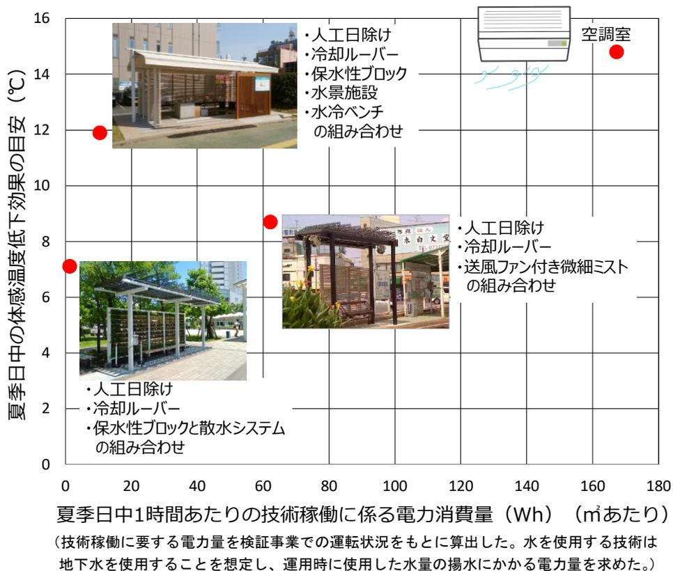
図 2.11 暑さ対策施設での電力消費量と体感温度低下効果の目安（H28 年度環境省検証事業より）
