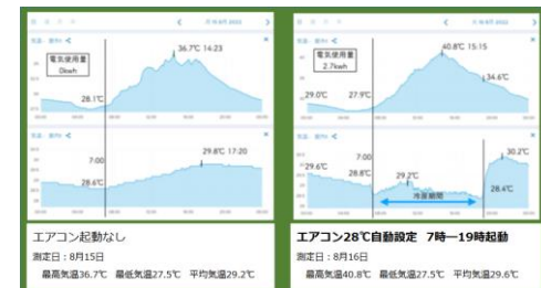
パターン2. 遮熱塗料あり、窓断熱なし、オーニング（日よけ）なし
