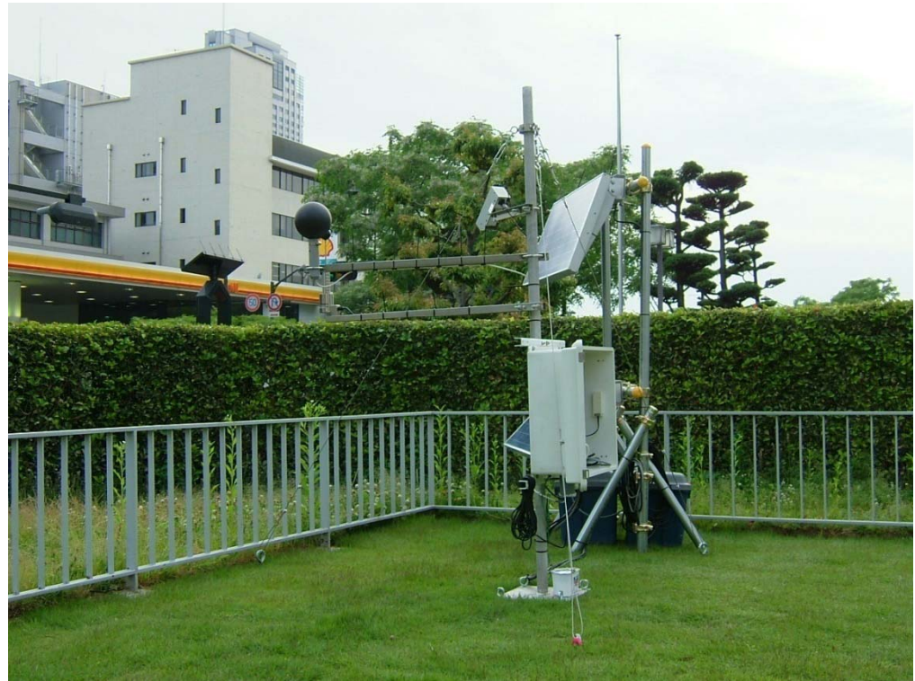
WBGT計の設置状況
